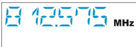
Drücken Sie die Taste kurz, wechselt die Anzeige zum nächsten bzw. vorherigen Wert. Wenn Sie in den Menüpunkten „CHAN“, „TUNE“ und „NAME“ die Wipptaste ▲/▼ gedrückt halten, ändert sich die Anzeige fortlaufend (Repeat-Funktion). Sie gelangen so in beiden Richtungen schnell und komfortabel zum gewünschten Einstellwert.
