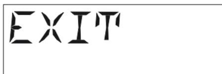
Wenn Sie innerhalb des Bedienmenüs die Taste **ON/OFF** kurz drücken, brechen Sie die Eingabe ab (ESC-Funktion) und kehren ohne Änderung zur Standardanzeige mit den zuletzt gespeicherten Einstellungen zurück.
